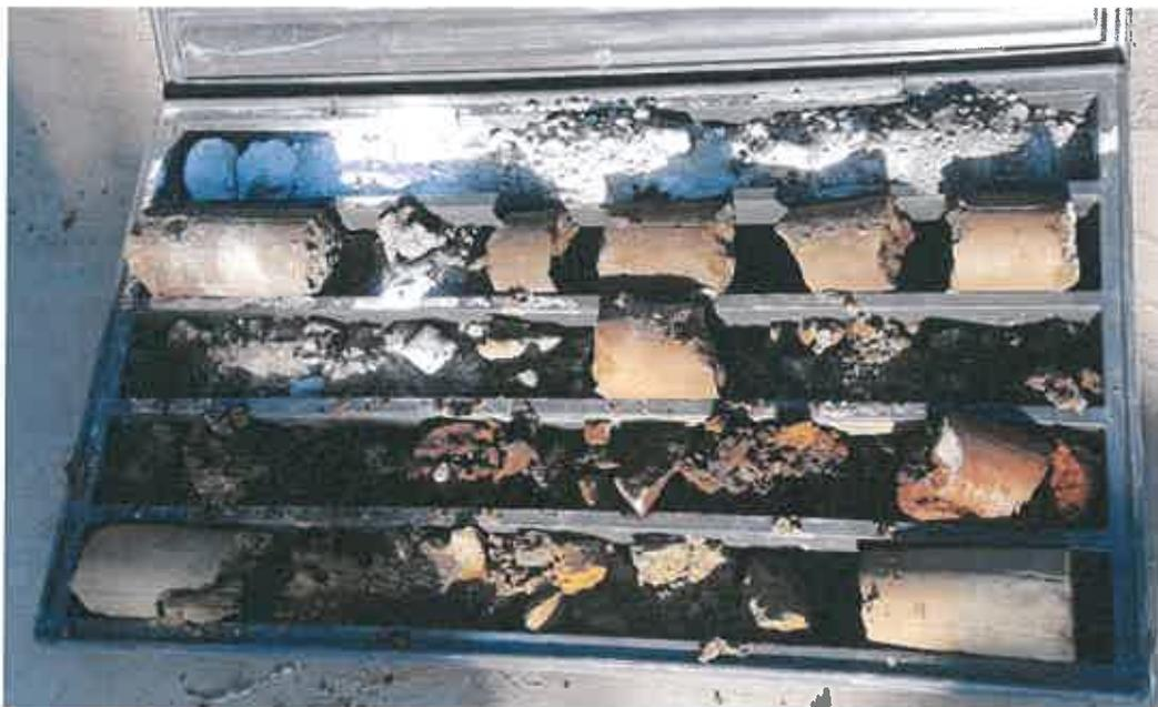
Il primo metro di profondità di tutti i sondaggi citati era rappresentato principalmente dal sistema impermeabilizzazione (cemento) della pavimentazione del piazzale e dal relativo materiale inerte di predisposizione al sistema di impermeabilizzazione. Per quanto descritto la prima aliquota di campione è stata prelevata oltre il primo metro in quanto a tale profondità cominciava la matrice TERRENO oggetto di indagine.
